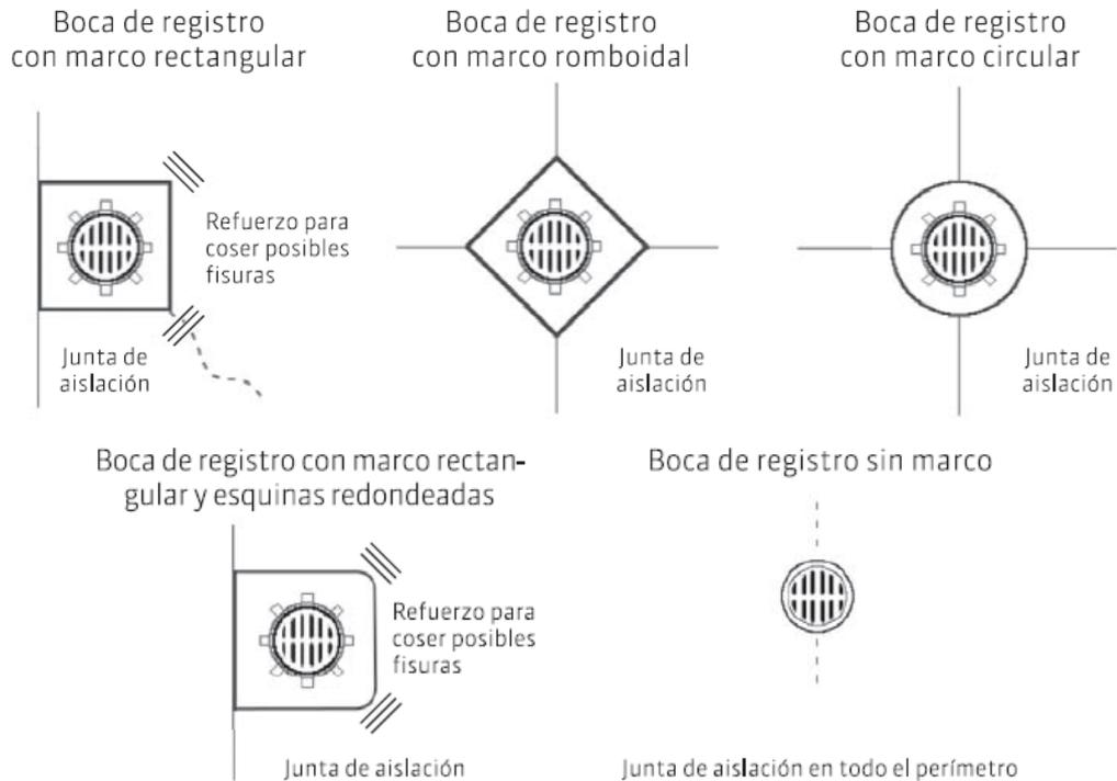
Detalle de Alternativas posibles para estructuras fijas de bocas de registro y de drenaje
